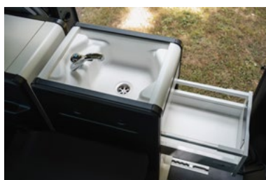
Bloc cuisine (point d'eau avec évier comprenant 2 réserves de 12l, eau propre et eaux usées)
